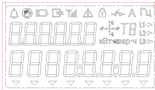
*Рисунок 4.5.* LCD дисплей счетчика РТМ-01(В).
