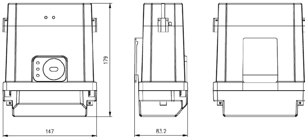
*Рисунок 6.6. Размеры счетчика РОТЕК РТМ-01(С2)*
