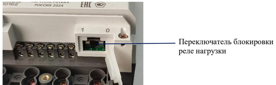
Рисунок 3.3 Переключатель блокировки реле нагрузки в счетчиках РТМ-03(D) (версия 2024 г.).
