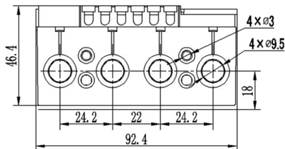
Рисунок 3.7. Расположение и размеры клемм
