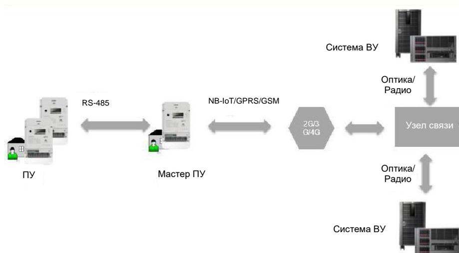
Рисунок 8.1 Схема ретрансляции через мастер-счетчик
