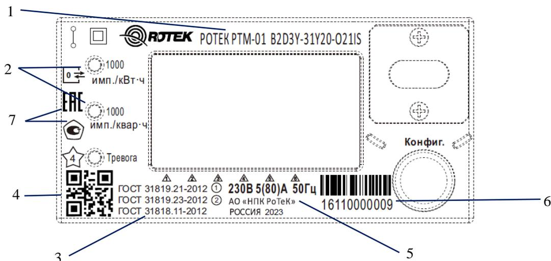
Рисунок 4.3 Обозначения на лицевой панели счетчика РОТЕК РТМ-01(В)
