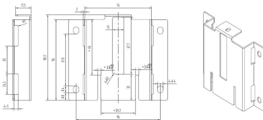
*Рисунок 5.7. Металлический держатель для крепления на опоре и настенного монтажа*
