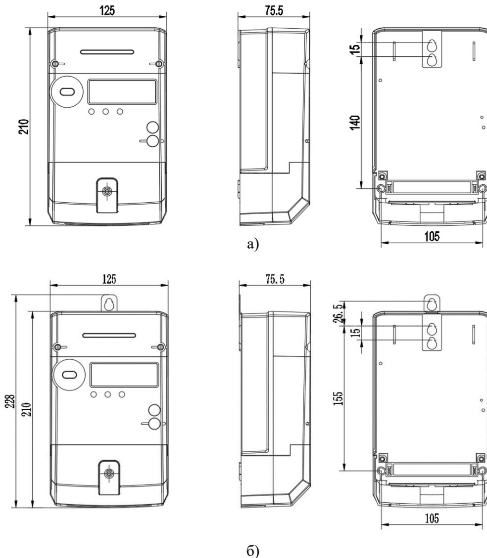
Рисунок 3.6. Габаритные размеры счетчика РОТЕК РТМ-01 (D) с длинной (а) и короткой (б) терминальной крышкой
