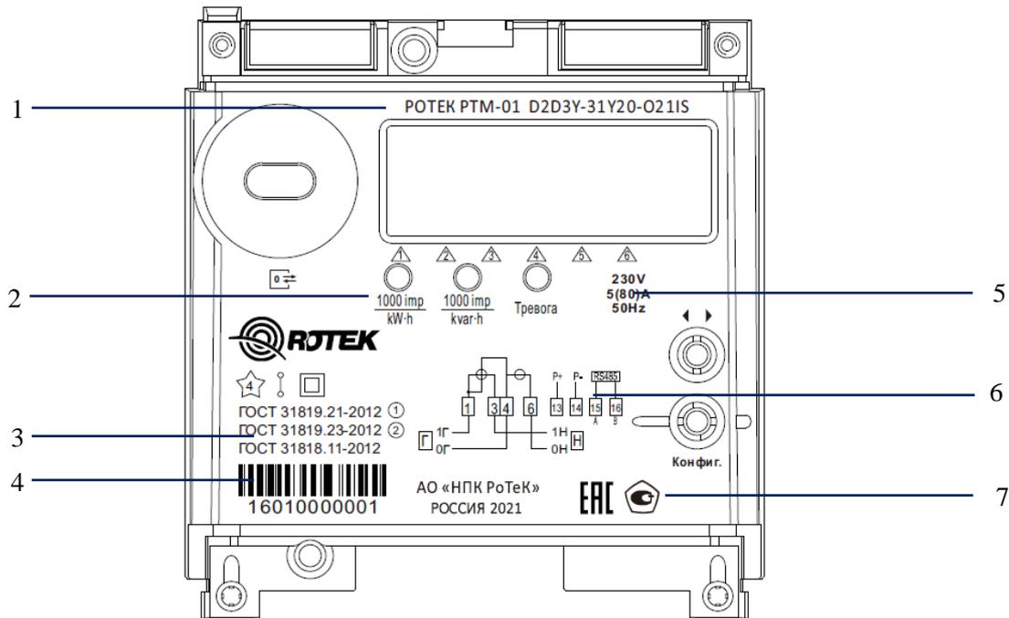
Рисунок 3.2 Обозначения на лицевой панели счетчика POTEK PTM-01(D) со встроенным дисплеем
