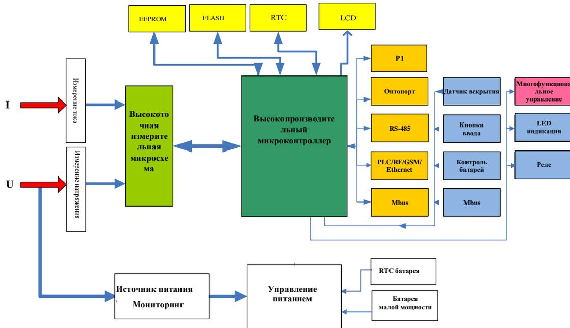
Рисунок 1.2 Блок-схема счетчика РОТЕК PTM-01
