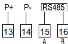
13/14 – испытательные импульсные выходы активной и реактивной энергии и тактовых импульсов 1 сек. (программный выбор)
