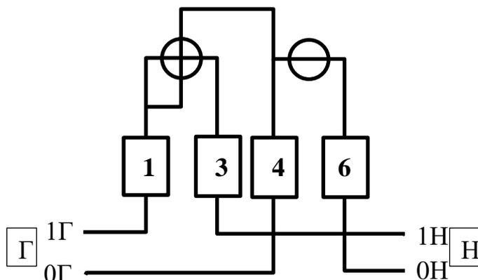
Рисунок 3.8. Схема подключения силовых контактов
