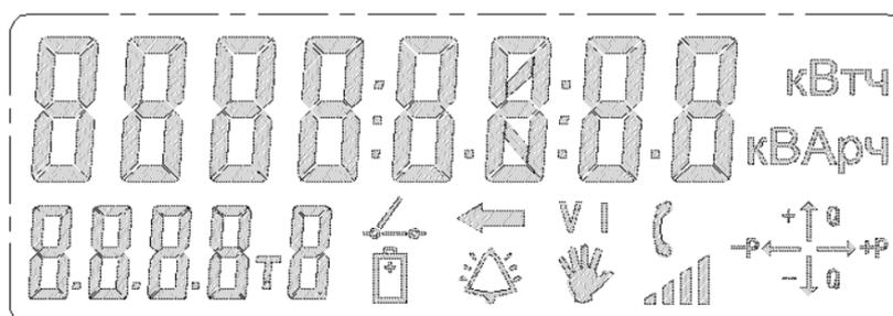
*Рисунок 5.5. Символы LCD дисплея счетчика РОТЕК РТМ-01(С1)*
