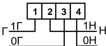
Рисунок 5.3. Схема подключения счетчика РТМ-01(С1) к силовой сети.
