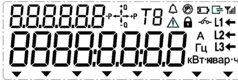
Рисунок 3.5. LCD дисплей (версия 2024 г.).
