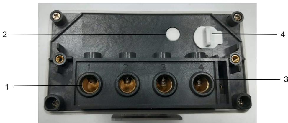
*Рисунок 6.2. Расположение выводов и контактов счетчика РТМ-03(С2) в сплит-исполнении.*
