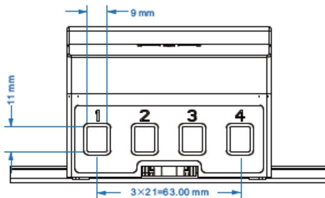
Рисунок 4.7. Расположение и размеры клемм счетчика РОТЕК РТМ-01(В)
