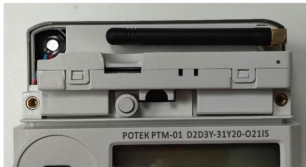
б) Модуль, установленный в ПУ
