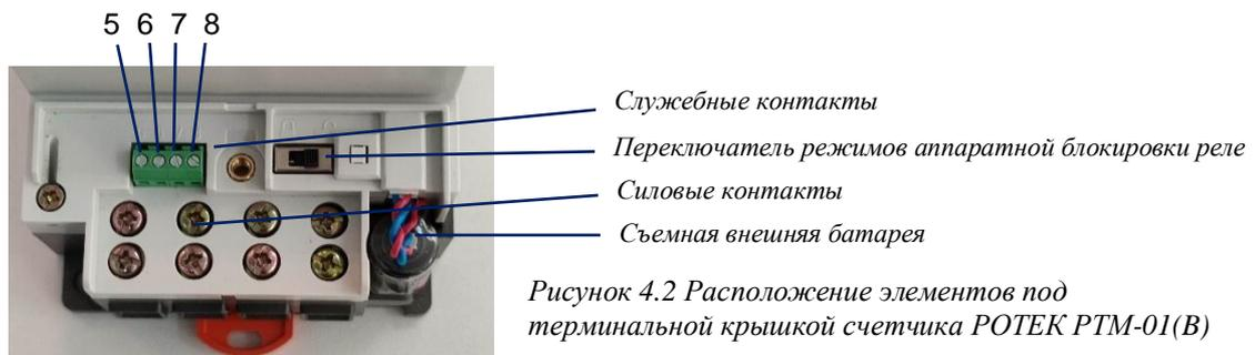
Рисунок 4.2 Расположение элементов под терминальной крышкой счетчика РОТЕК РТМ-01(В)
