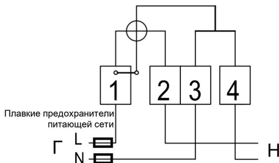
Рисунок 7.1 Соединение счетчика с проводами фазы и нейтрали
