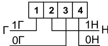
Рисунок 6.3. Схема подключения счетчика к силовой сети
