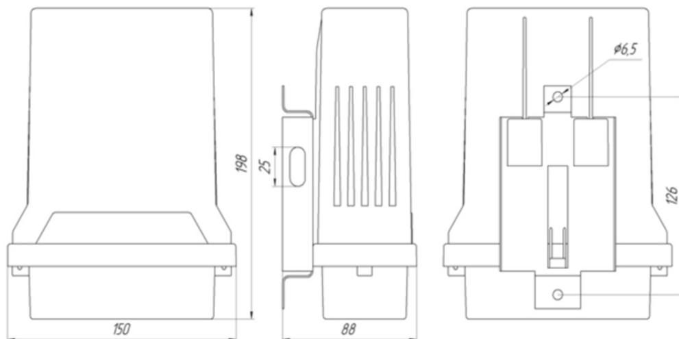
*Рисунок 5.6. Размеры счетчика РОТЕК РТМ-01(С1)*
